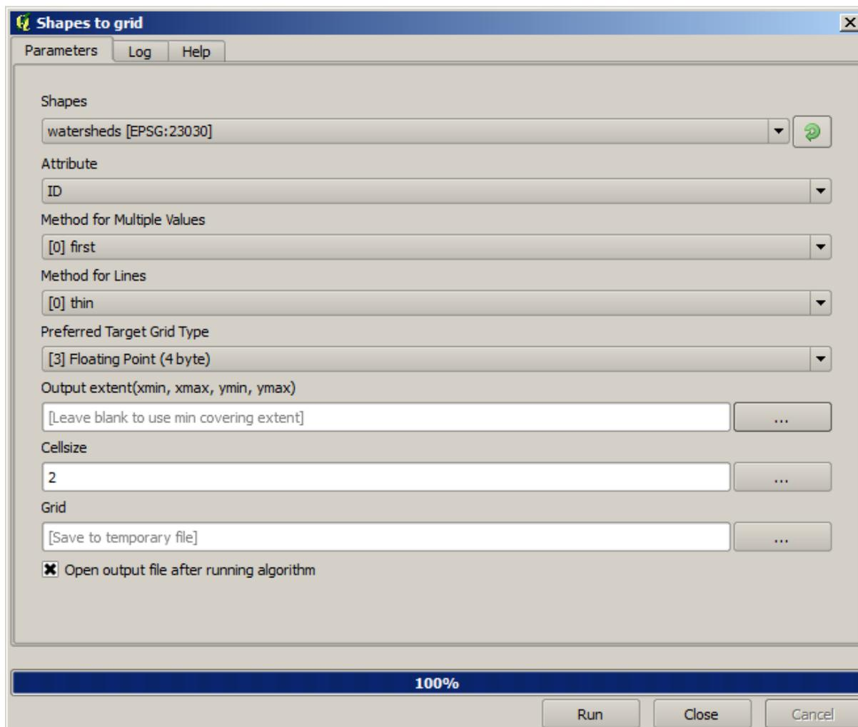
**Note:** Dans ce cas, utilisez plutôt un *entier* (1 octet) au lieu d'un *réel* (4 octets), car *NAME* est un entier ayant une valeur maximum=64. Une taille de fichier plus petite et des calculs plus rapides en résulteront.
