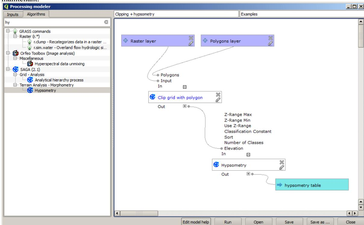
Sélectionnez le MNE et les bassins versants, et n'oubliez pas d'utiliser le bouton qui indique que l'algorithme doit être exécuté itérativement.
