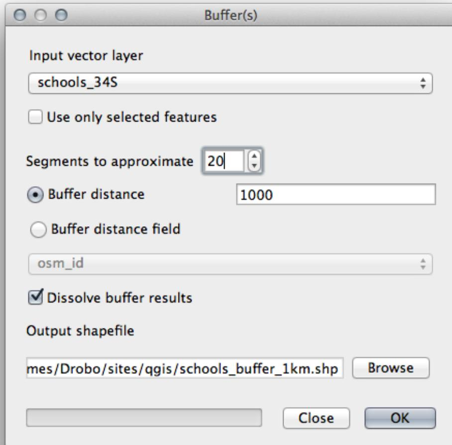
La *Distance tampon* est 1000 mètres (c'est-à-dire, 1 kilomètre).
