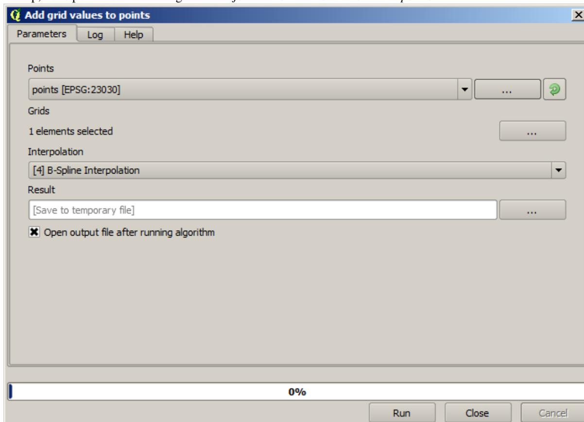
La couche raster à sélectionner (l'algorithme supporte plusieurs rasters, mais nous n'en avons besoin que d'un) est celle qui résulte de l'interpolation. Nous l'avons renommée *interpolation* et ce nom de couche est celui qui sera utilisé pour le nom du champ à ajouter.
