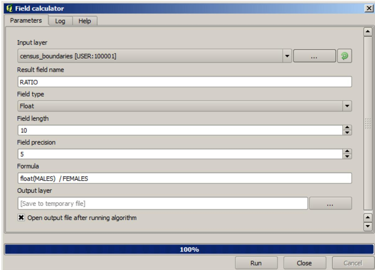
Dans la version précédente, les deux champs étant de type entier, le résultat sera tronqué en un entier. Pour indiquer que le résultat souhaiter doit être à virgule flottante, la formule devrait être:  $1.0 * \text{"MALES"} / \text{"FEMALES"}$ .
