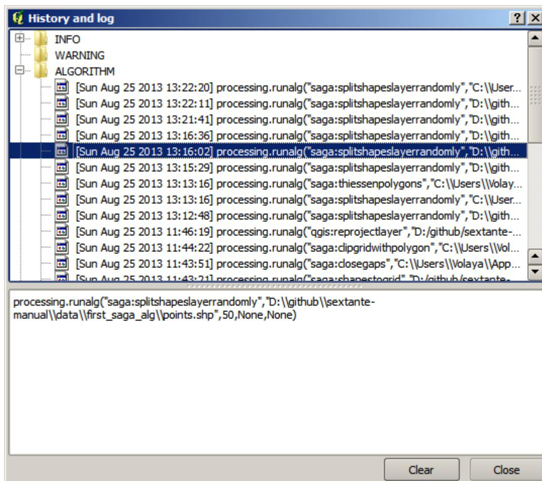
Il peut être très utile lorsque l'on commence à travailler avec la console, d'apprendre la syntaxe des algorithmes. Nous l'utiliserons lorsque nous discuterons de comment lancer des commandes d'analyses depuis la console.
