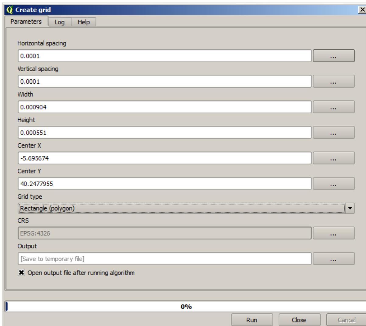
(Il est plus sage d'ajouter un espacement sur la largeur et la hauteur: Espacement horizontal: 0.0001, Espacement vertical: 0.0001, Largeur: 0.001004, Hauteur: 0.000651, X Centre: -5.695674, Y Centre: 40.2477955). Le cas du centre X est un peu compliqué:  $-5.696126 + ((-5.695222 + 5.696126)/2)$
