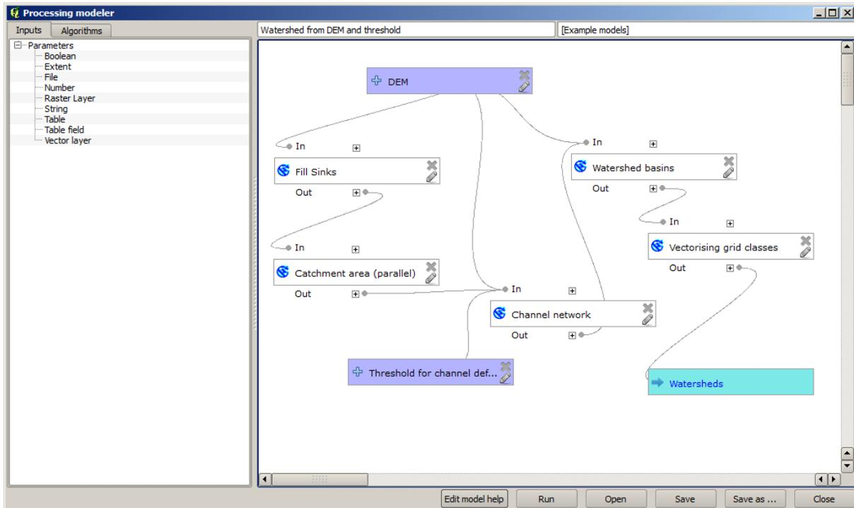
Le modèle est maintenant complet. Essayer de le lancer en utilisant le MNE que nous avons utilisé dans les leçons précédentes, et avec différentes valeurs de seuil. Ici vous avez un échantillon des résultats obtenus pour différentes valeurs. Vous pouvez comparer avec le résultat pour la valeur par défaut, qui est celui que nous avons obtenu dans la leçon d'analyse hydrologique.
