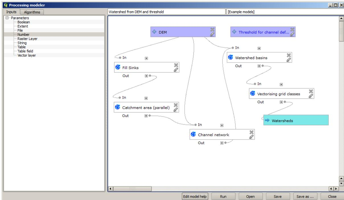
L'entrée que nous venons juste d'ajouter n'est pas utilisée, donc le modèle n'a pas réellement changé. Nous devons lier cette entrée à l'algorithme qui l'utilise, dans ce cas, le Réseau de canaux. Pour modifier un algorithme qui existe déjà dans le modèleur, cliquez simplement sur l'icône crayon de la boîte correspondante dans le canevas. Si vous cliquez sur l'algorithme Réseau de canaux, vous verrez quelque chose comme ça.
