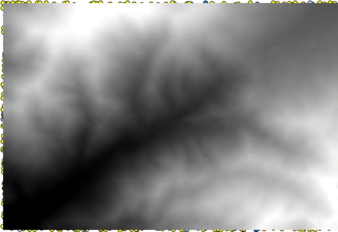
Pour vérifier la qualité de l'interpolation, nous pouvons maintenant utiliser les points qui n'ont pas été sélectionnés. Nous connaissons, en ce point, l'élévation réelle (la valeur dans la couche de points) ainsi que l'élévation interpolée (la valeur présente dans la couche raster interpolée). Nous pouvons comparer les deux en calculant leur différence.
