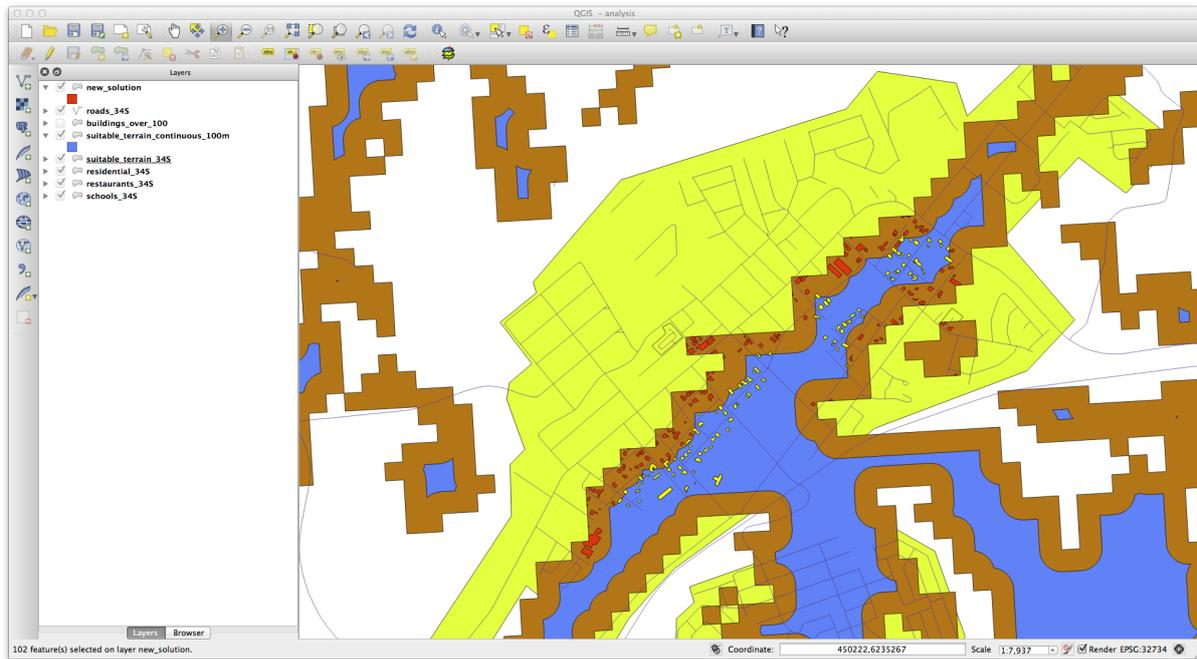
Les bâtiments jaunes sont sélectionnés. Bien que certains des bâtiments soient en partie à l'extérieur de la nouvelle couche *suitable\_terrain\_continuous100m*, ils se trouvent bien dans la couche d'origine *suitable\_terrain* et répondent donc à toutes nos exigences.
