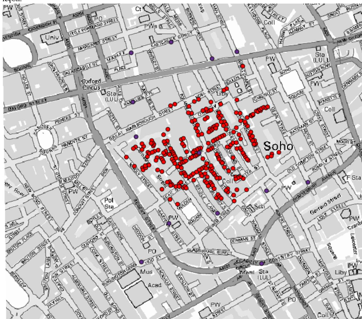
La première chose à faire est de calculer le diagramme de Voronoï (aussi connu sous le nom des polygones de Thyessen) de la couche des pompes, pour obtenir la zone d'influence pour chaque pompe. L'algorithme du *Diagramme de Voronoï* peut être utilisé pour cela.
