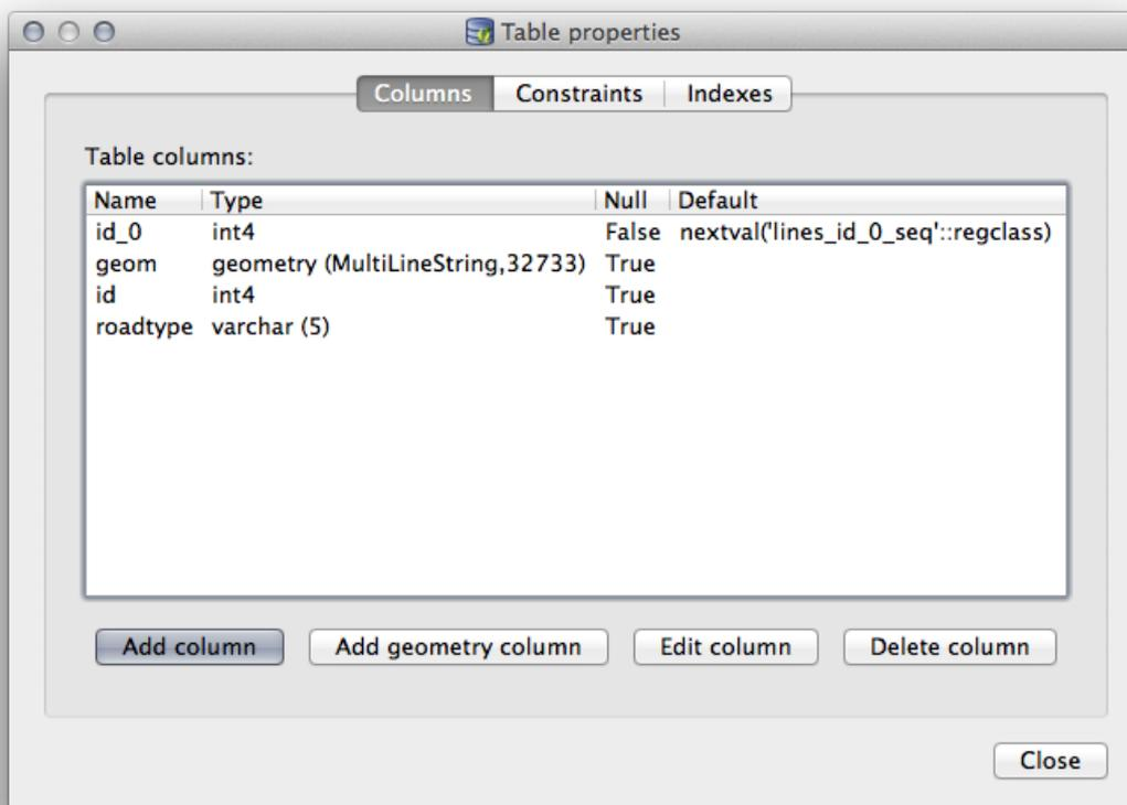
Vous pouvez utiliser cette fenêtre pour ajouter des colonnes, ajouter des colonnes géométriques, éditer des colonnes existantes ou supprimer complètement une colonne.
