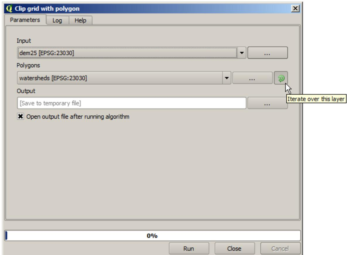
Ce bouton permettra à la couche d'entrée sélectionnée d'être séparée en autant de couches qu'elle a de caractéristiques, chacune d'entre elles contenant un simple polygone. Sur ce, l'algorithme sera appelé de manière répétitive, une fois pour chacune des couches de polygone unique. Le résultat, à la place d'une seule couche raster dans le cas de cet algorithme, sera un ensemble de couches raster, chacune d'entre elles correspondant à une des exécutions de l'algorithme.
