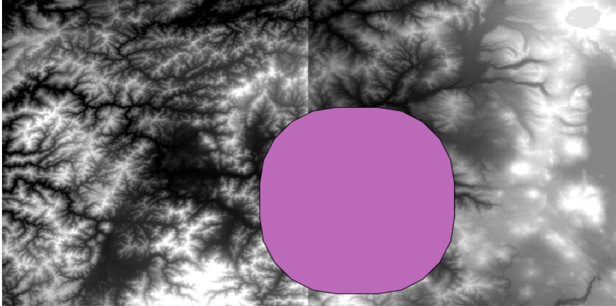
Il s'agit d'un rectangle arrondi, mais nous pouvons facilement obtenir l'emprise équivalente avec des angles droits, en lançant sur elle l'algorithme *Créer un polygone à partir de l'emprise de la couche*. Nous aurions pu créer un tampon sur les limites de la ville d'abord et ensuite calculer l'emprise rectangulaire, ce qui nous aurait économisé une étape.
