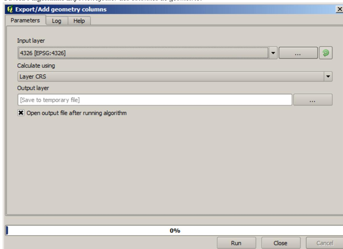
Cet algorithme ajoute des nouvelles colonnes aux tables attributaires d'une couche vectorielle. Le contenu des colonnes dépend du type de géométrie de la couche. Dans le cas des points, de nouvelles colonnes avec les coordonnées X et Y de chaque point sont ajoutées.
